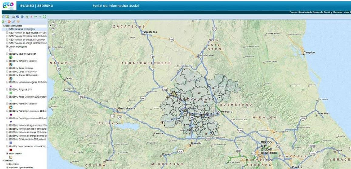
En la Figura 37 se observa que la pantalla se divide en tres áreas importantes, en el lado superior izquierdo de la pantalla se muestra la barra de herramientas de manera horizontal, en el lado inferior izquierdo se presentan de forma vertical los temáticos con los cuales podrá elaborar los mapas y de lado derecho el área del mapa donde observará los resultados de la consulta realizada.
