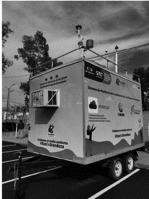
Figura 41. Laboratorio móvil de calidad del aire, para la medición de compuestos orgánicos volátiles, azufrados y carbono negro.
